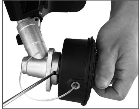
Рис. 10 Установка триммерной головки
