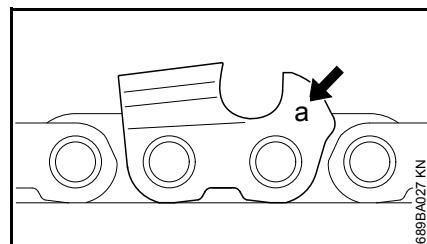
Обозначение (а) шага цепи выгравировано в области ограничителя глубины реза каждого режущего зуба.
