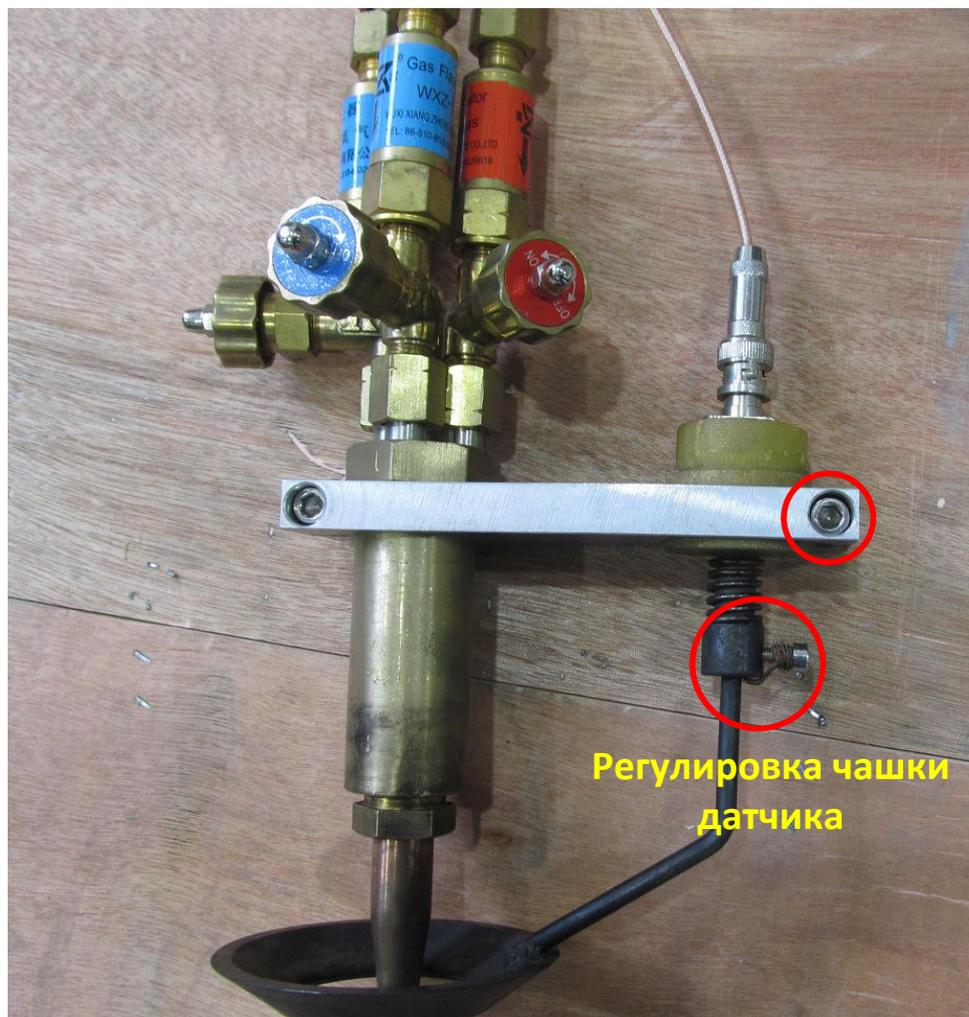
Рис.70 Винты регулировки высоты чашки емкостного датчика
