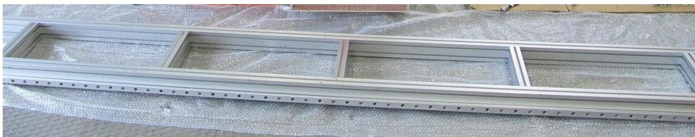
Рис.4 Комплектующие станка. Основной рельс (вид снизу)
