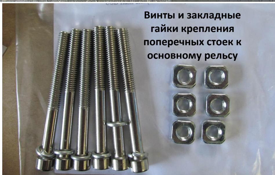
Рис.8 Комплектующие станка. Поперечные стойки основного рельса. Винты и закладные гайки крепления поперечных стоек к основному рельсу.
