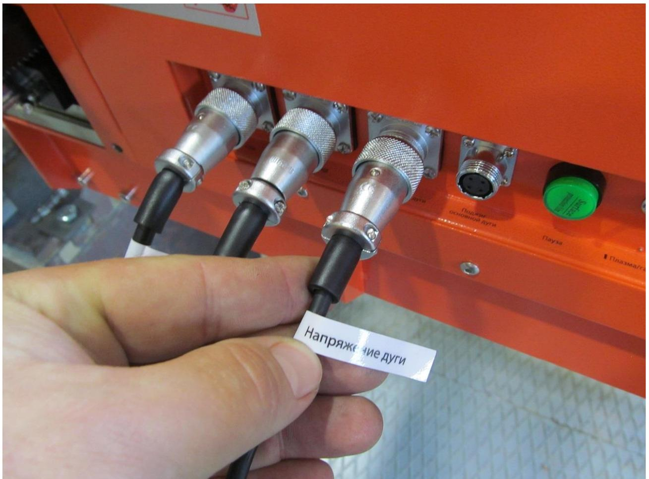
Рис. 40 Подключение кабеля «Напряжение дуги»
