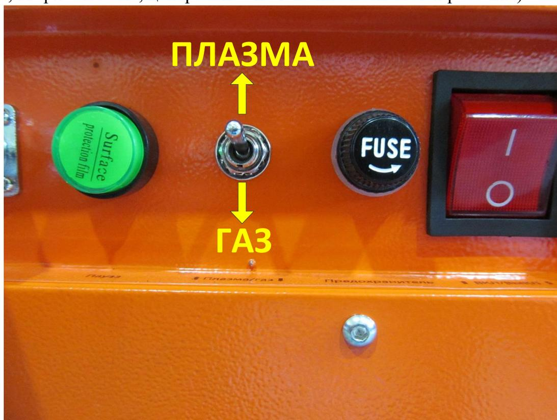
Рис.61 Тумблер режима работы «Плазма/Газ»
