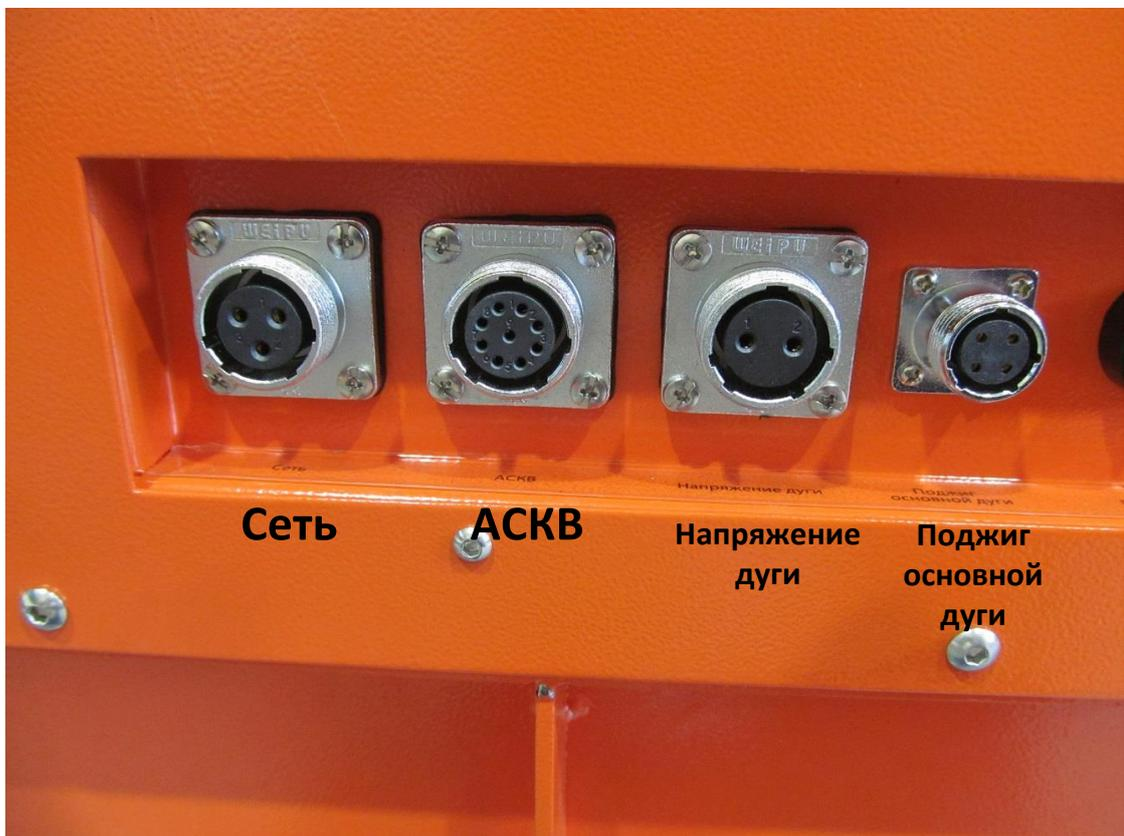
Рис. 37 Бирки разъемов контроллера (под разъемами)
