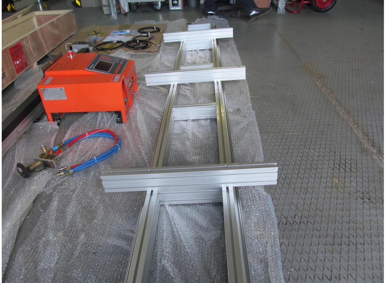
Рис. 16 Прикрученные стойки к основному рельсу
