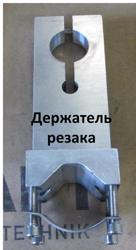
Рис.7 Комплектующие станка. Блок автоматической системы контроля высоты (АСКВ) с винтами крепления. Держатель резака
