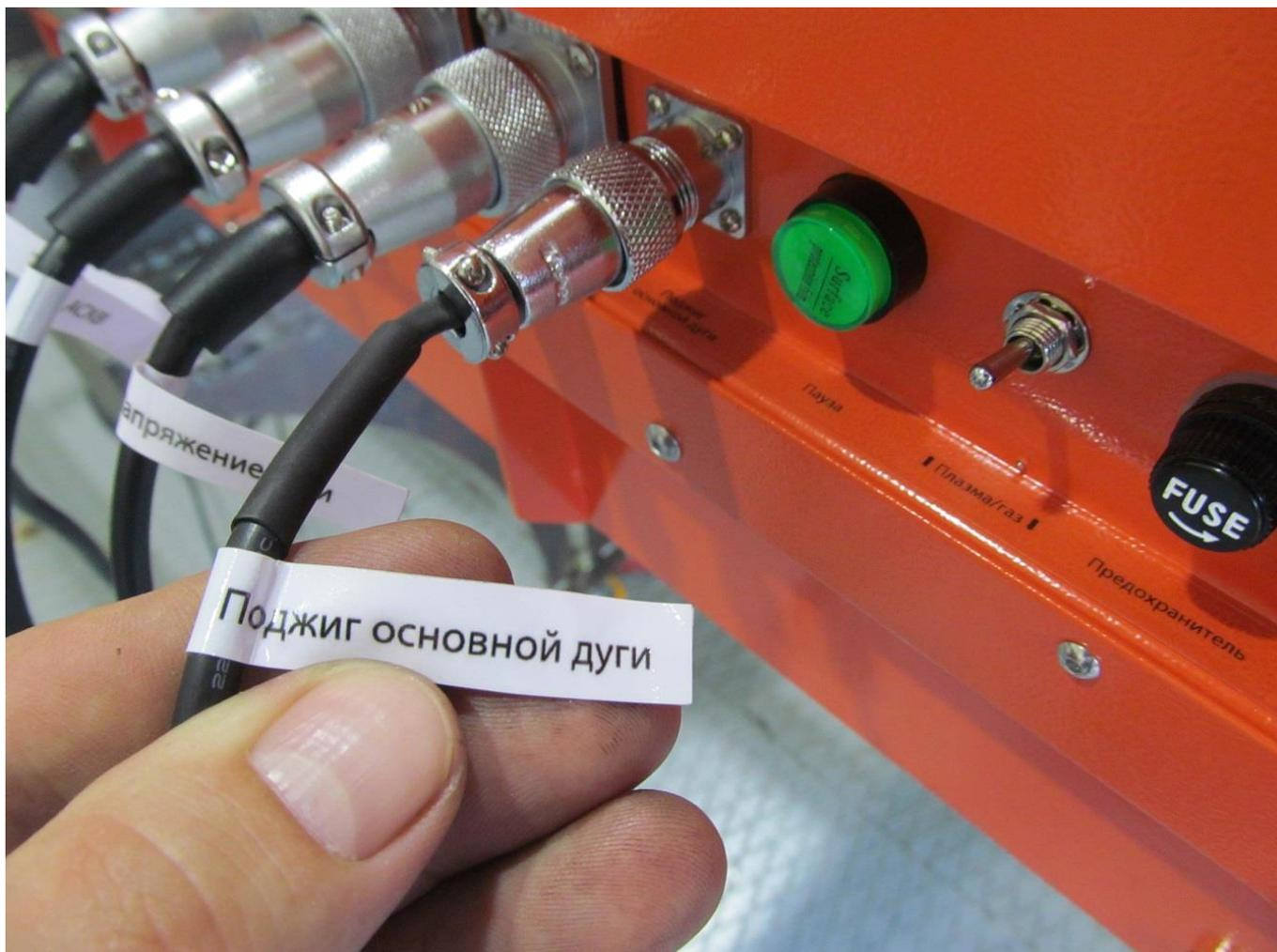
Рис. 41 Подключение кабеля «Поджиг основной дуги»
